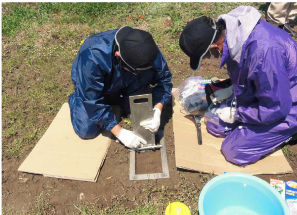
図-2 スクレーパープレートによる土壌採取の様子
